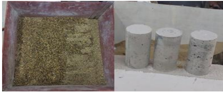
Figura 1. Resíduo do café (casca triturada) e corpos de prova do concreto produzido.
