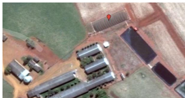
Figura 2. Exemplo de uma imagem de satélite com biodigestor inflado.
