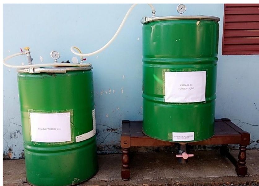
Figura 1. Biodigestor construído para a produção de biogás a partir de dejetos bovinos.
