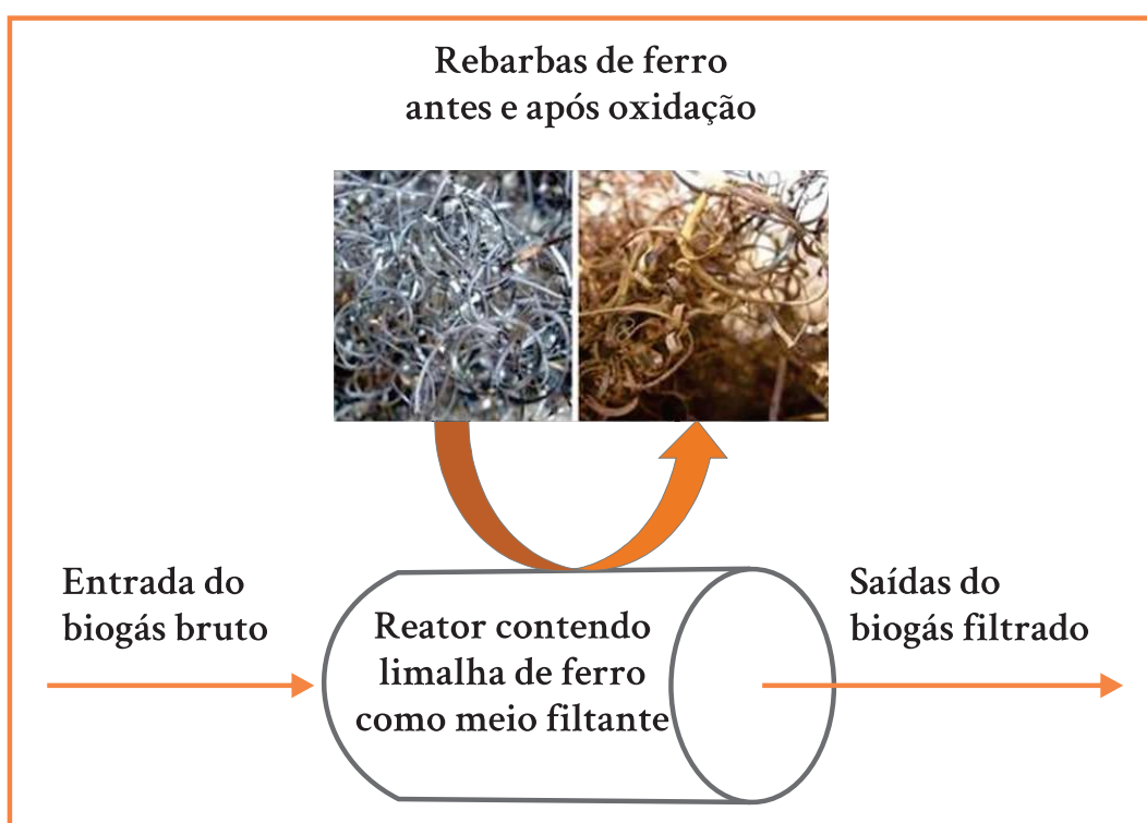
Figura 5. Esquema de um filtro instalado em série na linha de biogás contendo limalha de ferro como material adsorvente. Detalhe de oxidação da limalha de ferro.
